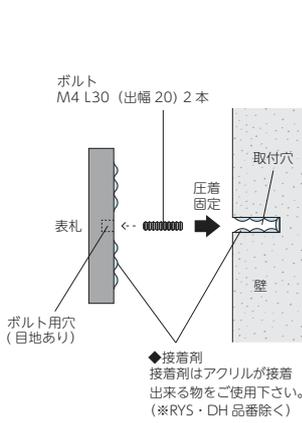
裏側にボルト用の穴が開いていますので付属のボルトを回し込み固定します。
