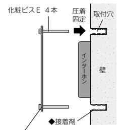
アンカーシャフトを回し込み、本体を挟み込む形で固定します。
