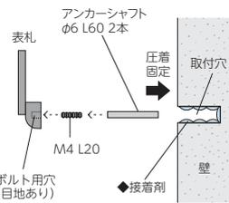
裏側にボルト用の穴が開いていますので付属のボルトを回し込み固定し、アンカーシャフトを回し込んで固定して下さい。
