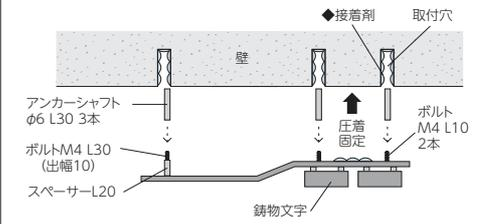
裏面にボルトが付いているので付属のスペーサー、アンカーシャフトを回し込んで固定して下さい。
