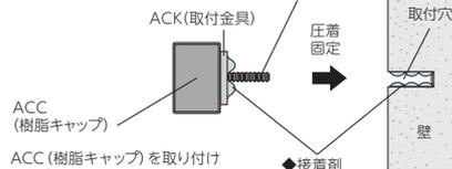
ACC(樹脂キャップ)を取り付ける場合は壁面に固定する前に取り付けて下さい。
