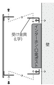
壁面に受け金具を先に付け、側面よりネジにてインターホンカバーを取り付けて下さい。
