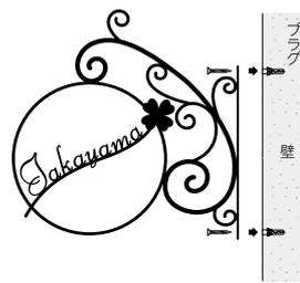
壁面にプラグを打ち込み、ネジを締めこんでお取り付け下さい。
