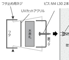
ステンレスケースの裏フタをビスで壁面に取り付け、木表札とUVアクリルをはめ込み、フタをします。フタは上下でネジ止めします。木表札は固定しない為、上下のネジを外せばいつでもお掃除や交換が可能です。
