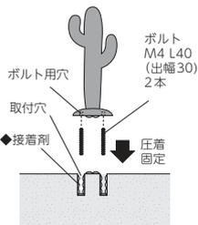
ボルト用の穴が開いていますので付属のボルトを回し込み固定します。
