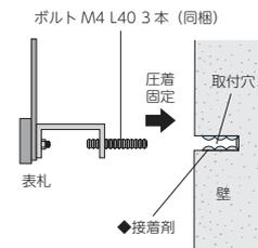
アクセントラインと組み合わせて施工する場合はアクセントラインを先に壁へ取り付ける必要があります。
