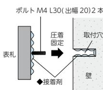
必ず接着剤を併用して取り付けして下さい。
