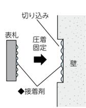
壁に表札より少し大きく切り込みを入れます。切り込み面を掃除して接着剤を塗布し、圧着固定します。
