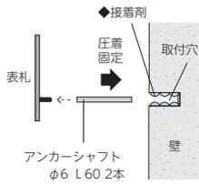
裏側にボルトが付いているので付属のアンカーシャフトを回し込んで固定して下さい。
