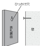
釘の頭を穴の大きい部分で通して狭い部分で引っかけられるような加工を施してあります。壁に釘頭が少し出るように釘を打ち、出っ張った釘頭に引っかけて取り付けして下さい。取り外せないようにするにはボンド等を併用して下さい。
