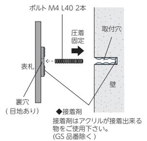
裏側にボルト用の穴が開いていますので付属のボルトを回し込み固定します。
