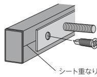
ACKを付属のドリルビットを使いAC裏面に固定してください。
